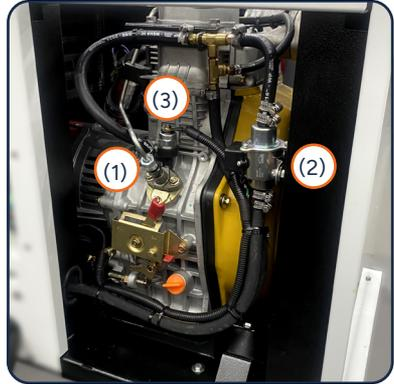
Bomba injetora (1), Bomba elétrica (2) e Solenóide de corte de combustível (3)
