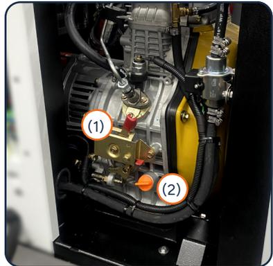
Alavanca de desligamento manual de emergência (1) e vareta de inspeção do óleo (2)
