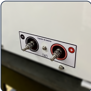
Ligação dos cabos da bateria
