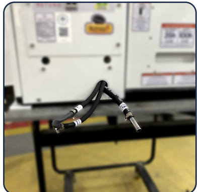
Conectores das mangueiras de combustível e água de refrigeração
