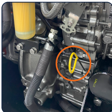
Vareta de inspeção do óleo
