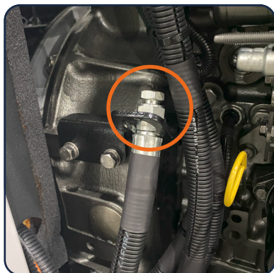
Dreno para remoção do óleo lubrificante
