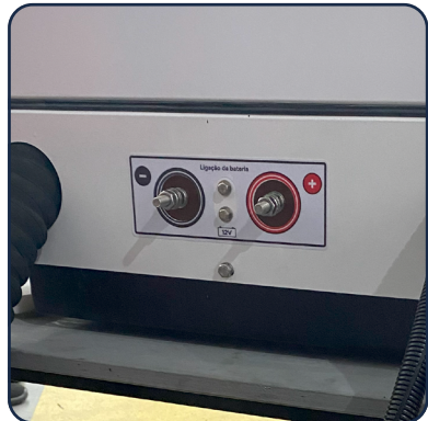
Ligação dos cabos da bateria
