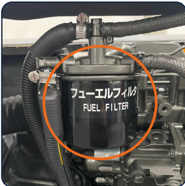
Filtro de óleo combustível
