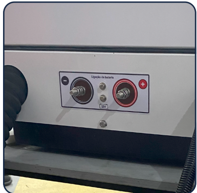
Ligação dos cabos da bateria
