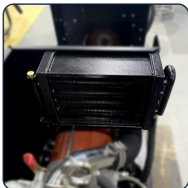
Radiador e ânodo de sacrifício
