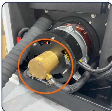
Bomba de refrigeração
