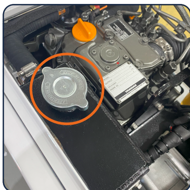
Tanque de água
