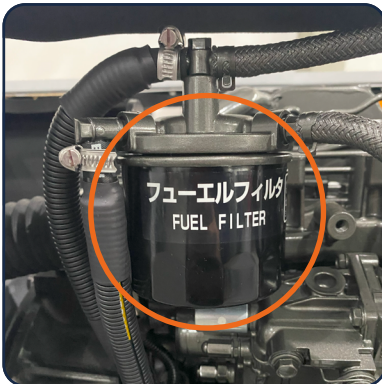
Filtro de óleo combustível
